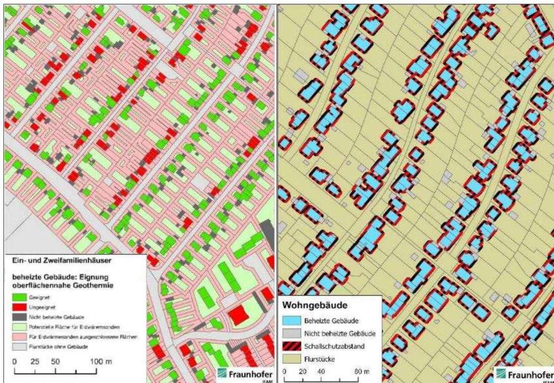
Abbildung 6: Eignungsprüfung Erd- und Luftwärmepumpen
