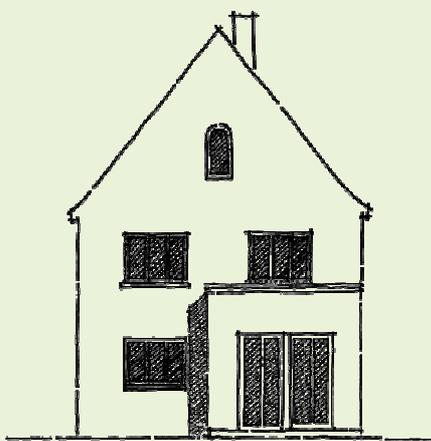
Abb.3: Anbaubeispiel Teilanbau mit nutzbarer Dachfläche
