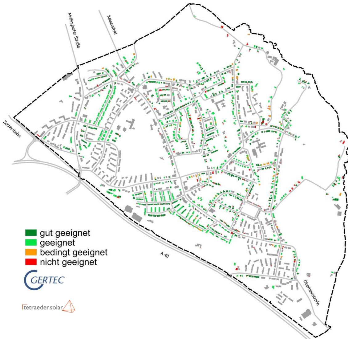
Abbildung 64: Solarenergie-Potenzial auf EFH und RH (Quelle: tetraeder.solar).
