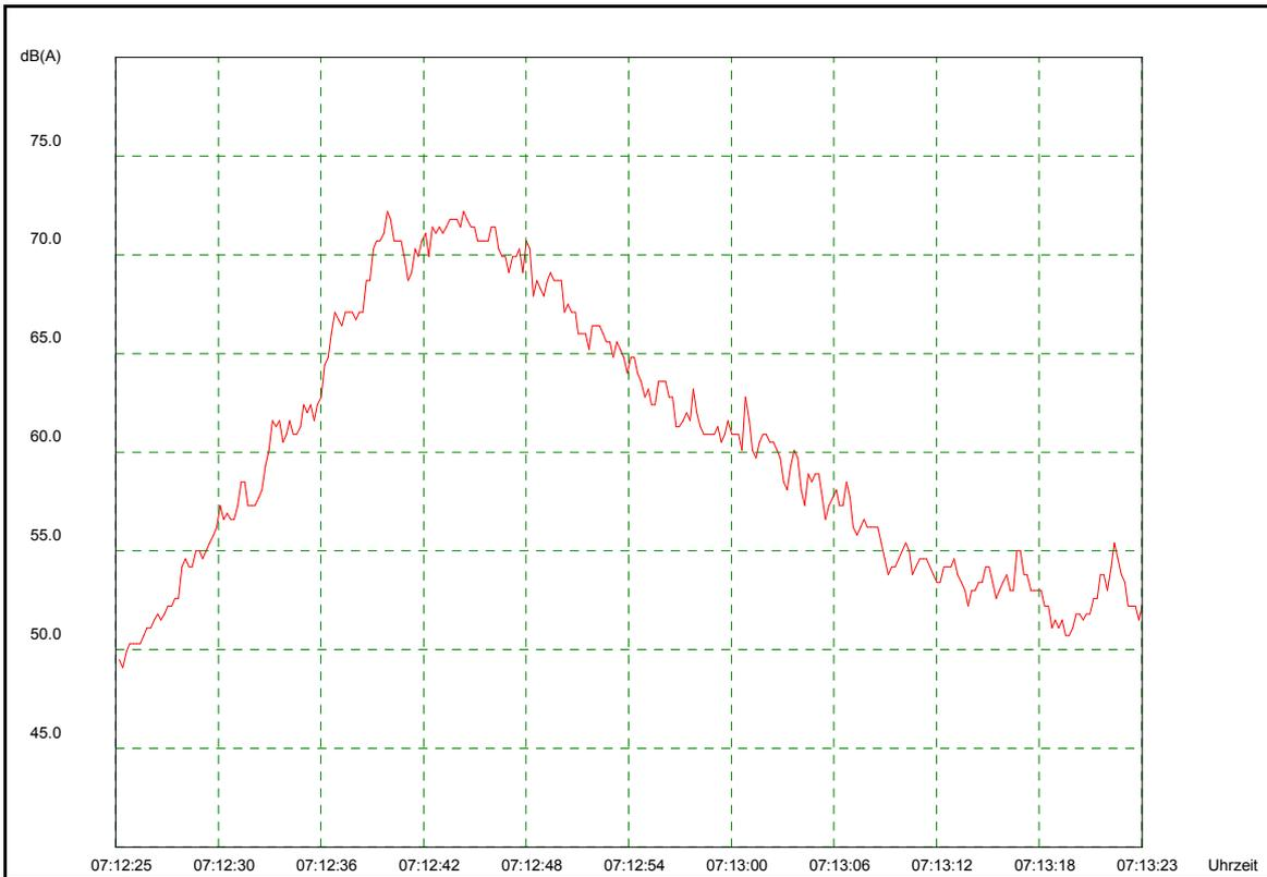
Abbildung 4.1.1: Charakteristischer Pegelverlauf bei einem Überflug am MP 2
