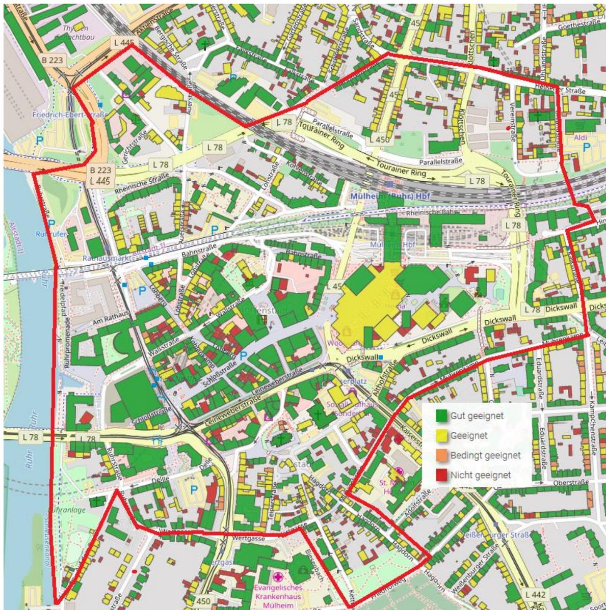
Abbildung 33: Auszug aus dem Solardachkataster mit PV-Potenzialen Quelle: <http://www.metropol Ruhr.de/regionalverband-ruhr/umwelt-freiraum/klima/klimaschutz/startseite-solardachkataster.html> ; zuletzt zugegriffen am 04.09.2017)
