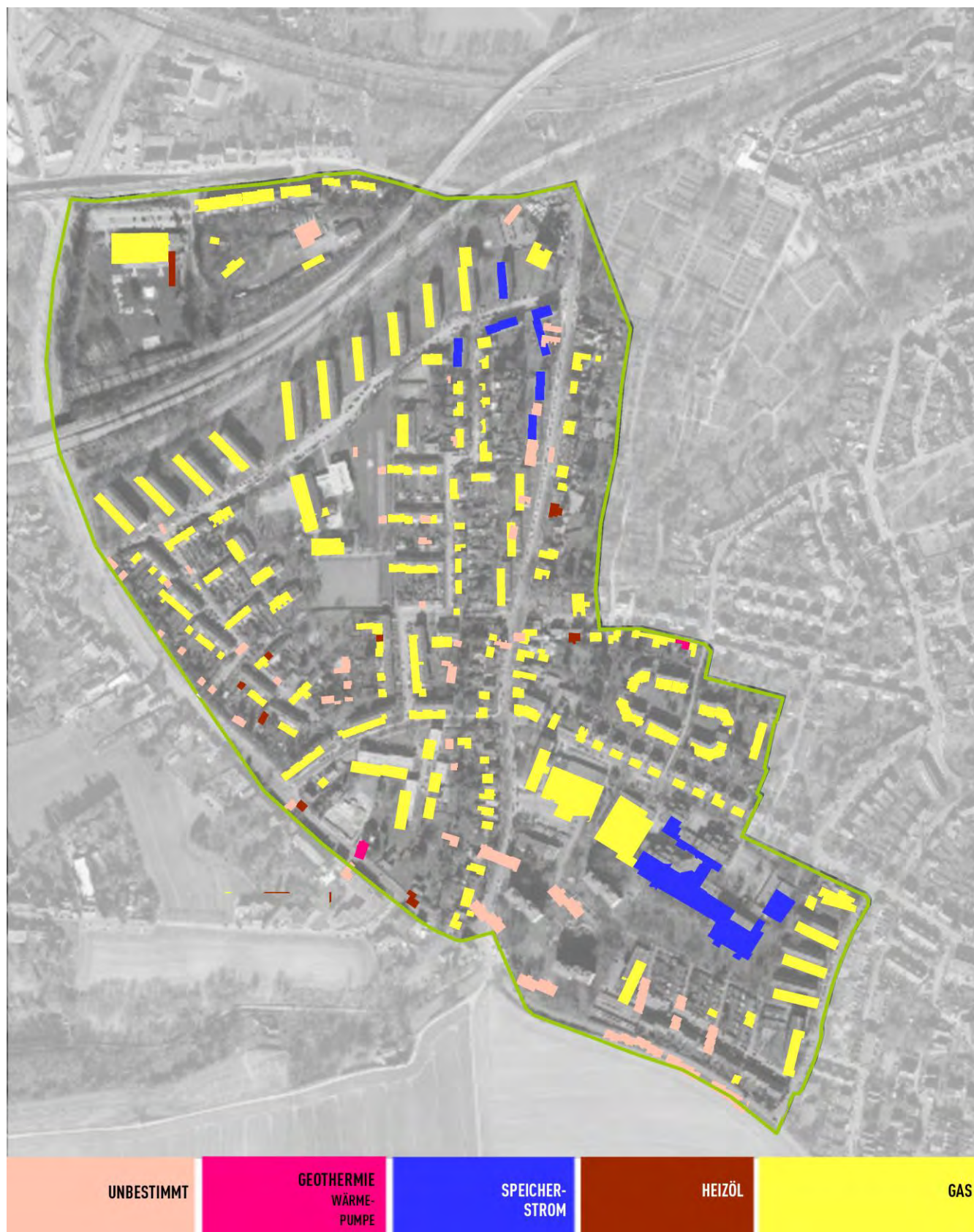
Abbildung 0.2: Energieträger zur Wärmeversorgung im Gebiet (Stadt Mülheim an der Ruhr 2016c, eigene Darstellung)
