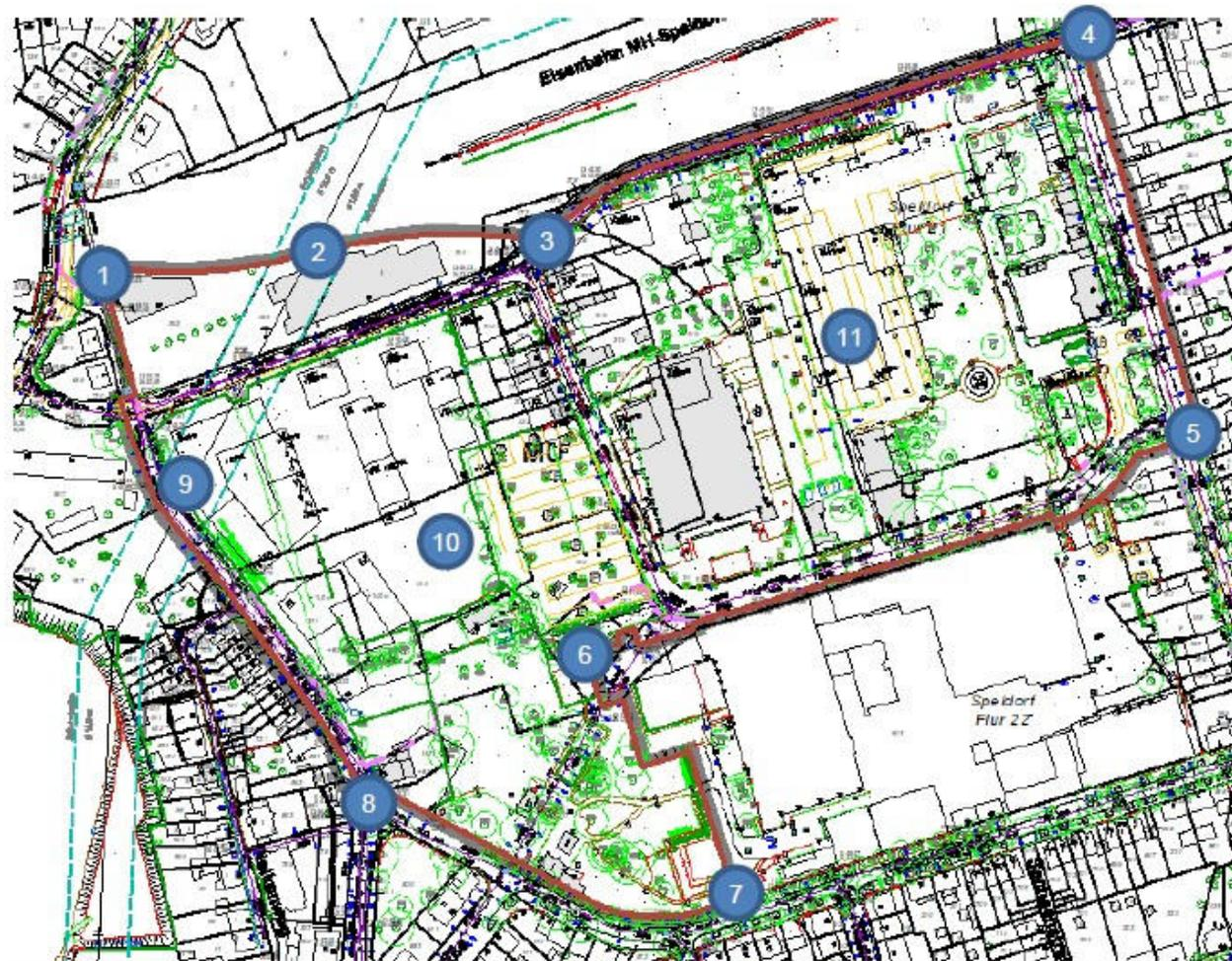
Abb. 3: Rechenmodell mit geplanten Gebäuden und Freileitungstrasse (magenta) – Blick Richtung Norden sowie Nummer von ausgewiesenen Immissionsorten.
